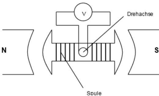
**Beobachtung:** Der Zeiger des Spannungsmessgeräts schlägt abwechselnd nach links und nach rechts aus. Die Spannung wechselt also ständig ihre Richtung → Wechselspannung
